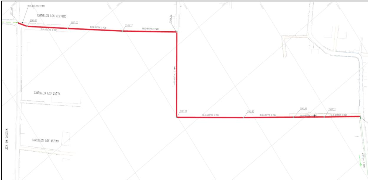
Figura No 1. Tubería de alcantarillado pluvial vía piedemonte a carrera novena, en diámetro veinte (20") pulgadas, material plástico (PVC o PEAD) y longitud de seiscientos (600 m) metros aproximadamente.
